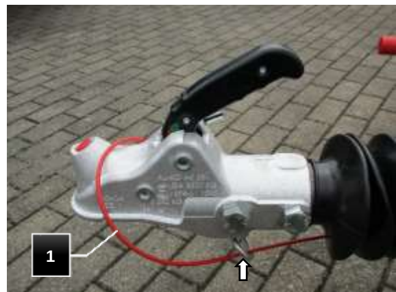
Kuva 72: Inertiajarrun irrotettava vaijeri
