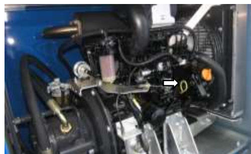
Kuva 81: Dieselmoottorin öljyn mittatikku
