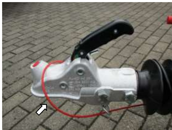
Kuva 51: Inertiajarrun irrotettava vaijeri
