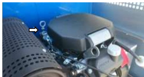
Kuva 80: Bensiniinimoottorin öljyn mittatikku
